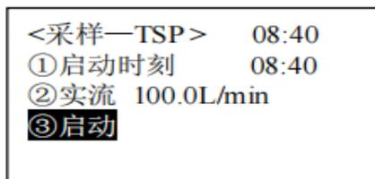
步骤 4：光标移动到启动，按确认开始采样。
