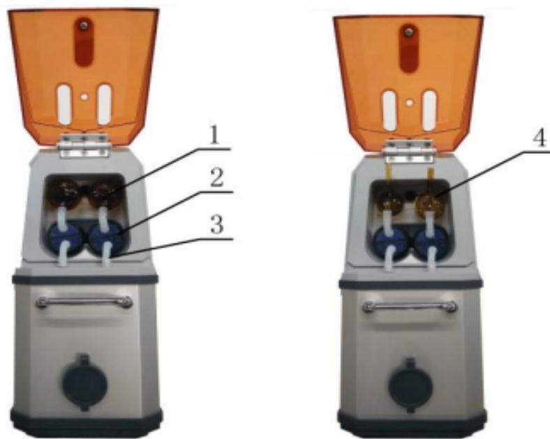
a) 24h 恒温恒流连续采样连接图      b) 短时采样连接图
